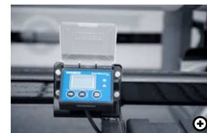
D SmartBoard SmartBoard podjetja Wabco prikazuje različne podatke o vozilu prek vgrajenega zaslona.
