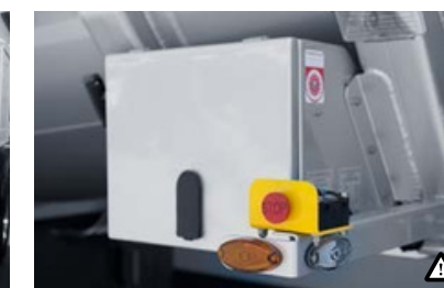
H Zasilni izklop Levo in desno je lahko dostopen zasilni izklop, ki prekine natovarjanje oz. raztovarjanje.
