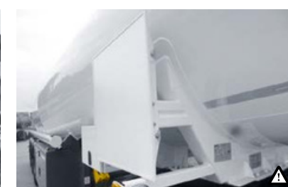
R Napisne table Dve bočno snemljivi napisni tabli v vtičnem okvirju. Uporabni na obeh straneh. Dimenzije pribl. 80 x 80 cm.
