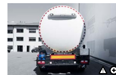
M Višje nameščene zadnje luči 2 višje nameščeni zadnji luči z nosilcem luči za večjo opaznost.
