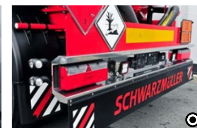
N Podletna zaščita iz nerjavečega jekla Visoko sijajna podletna zaščita iz nerjavečega jekla.
