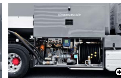
I Črpalna in merilna naprava Na voljo za sisteme s praznimi in polnimi cevmi. Kot alternativa elektronski merilni palici.
