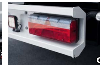
K LED-osvetlitev Zadnja luč je v standardni izvedbi izvedena kot delni LED. Kot opcijska različica opreme je možna tudi izvedba s polnim LED.
