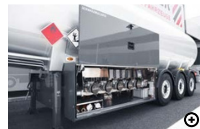
F Omara za armature po celotni dolžini Iz aluminija z žlebom za zbiranje proizvoda na obeh straneh. Na levi: priključek za povratni plin in API-polnilne spojke. Na desni: posamezni odtoki.
