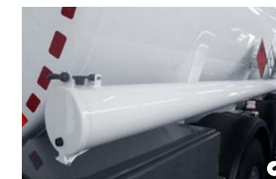
G cevni profili Vozilo je mogoče opremiti s 7,5 m dolgim cevnim rokvom.
