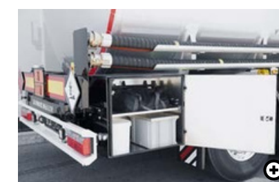
P Aluminijasti zaboj za pribor Bočno odpiranje vrat s kompresijskim zapiralom omogoča enostavno uporabo in dodaten prostor za razni pribor.
