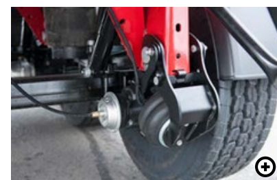
C Dvižna os Dvižne osi zmanjšujejo obrabo pnevmatik s samodejnim dvigom osi pri vožnji brez tovora. Služijo tudi kot pomoč pri speljevanju.
