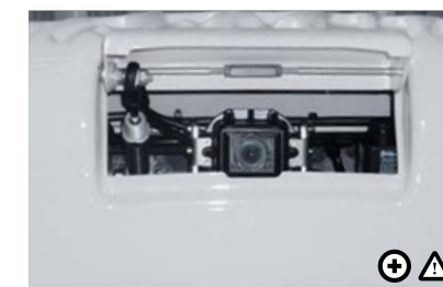
S Vzratna kamera Nudi dodatno varnost pri vzratni vožnji. Pokrov kamere se odpira pnevmatsko.
