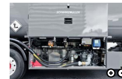
J Merilna naprava za prosti pad Namesto elektronske merilne palice je na voljo merilna naprava za prosti pad za izpust v prostem padu.
