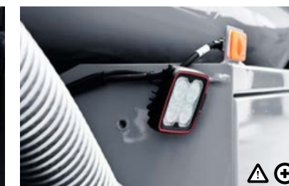
L Delovni žarometi LED-svetilke zagotavljajo dodatno osvetlitev med natovarjanjem in raztovarjanjem.
