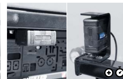
U Wabco Tail-Guard Varnostni sistem s tremi senzorji, ki združuje nadzor prostora za vozilom s samodejnim zaviranjem.
