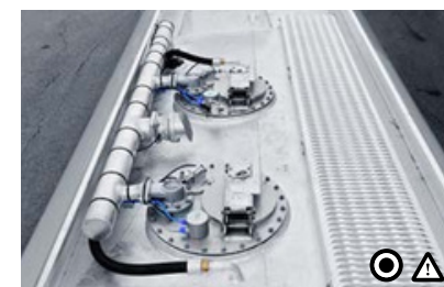
E Polnjenje od zgoraj (prelivna kad) Neprekinjena prelivna kad je opremljena s prehodom, zložljivo ograjo, kupolastim pokrovom s pokrovom za hitro polnjenje in vzpenjalno lestvijo.
