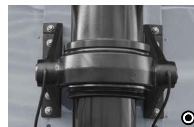
12 Štiritočkovno ležišče Prekucni cilindri je ležajno podprt na štirih mestih (po dvakrat zgoraj in spodaj). To ustvarja edinstveno prekucno stabilnost v primerjavi s tritočkovnim ležiščem.
