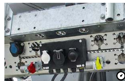
10 Priključki za zavore in luči Priključki za zavore in luči so skupaj z električnimi in hidravličnimi priključki kompaktno in pregledno razporečeni na čelni strani vozila.
