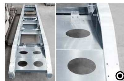
3 Vzporedni okvir Prednost v primerjavi z vozili mnogih konkurentov je vzporedna izvedba obeh vzdolžnih okvirjev. Tako nastane večja stabilnost v vsaki situaciji.
