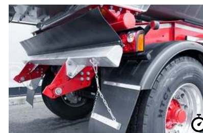
8 Zložljiva podletna zaščita Podletna zaščita je serijsko izvedena kot dvizigna (sklopljiva), da je pri polnjenju finišeja vedno zagotovljena potrebna oddaljenost od tal.
