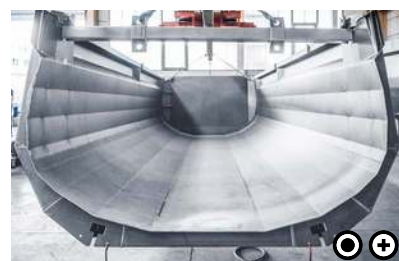
5 Jekleno korito Jekleno korito je 100-% izdelano iz dolgotrajnih pločevin. Tudi čelna in zadnja stena ter zgornji pas so iz tega kakovostnega materiala.
