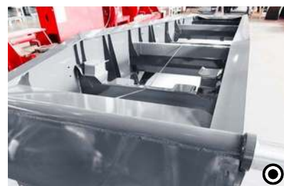
2 Torzijske cevi Te posebne prečne povezave podobno kot torzijski zaboj zagotavljajo dodatno stabilnost prekucne polprikolice med celotnim prekucnim postopkom.
