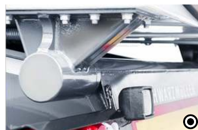
4 Enodelna prekucna gred Prekucna gred ni privarjena le ob straneh, temveč neprekinjeno po celotni dolžini. S to izvedbo se doseže večja stabilnost med prekucnim postopkom.
