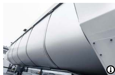
7 Thermo korito Korito je v celoti termično izolirano. Asfaltno mešanico je tako mogoče pripeljati na gradbišče pri višjih temperaturah, kar znatno poveča kakovost vgradnje.
