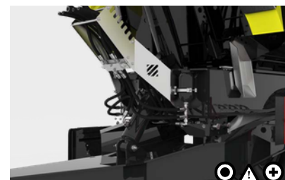
5 Hidravlično vzmetenje vlečne osi
