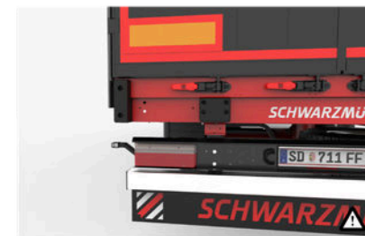
18 Zaščita pred udarci Ti gumijasti odbijaci ščitijo pred poškodbami pri primikanju k rampam.
