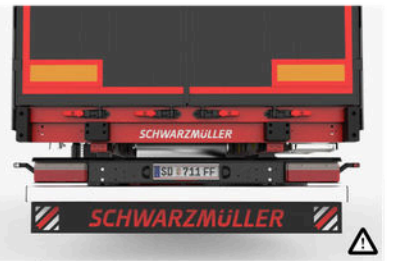
14 Podletna zaščita Preprečuje podletanje pod vozilo na zadnji strani in že ustreza novi uredbi EU od leta 2021 s povečanimi preizkusnimi silami.
