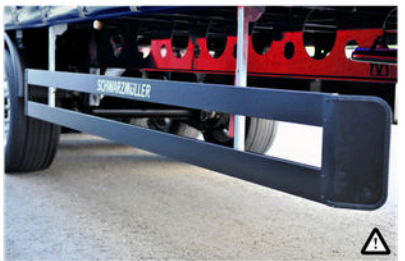
13 Bočna zaščita Zakonito predpisana zaščita za kolesarje, ki preprečuje, da bi ljudje padli pred kolesa.
