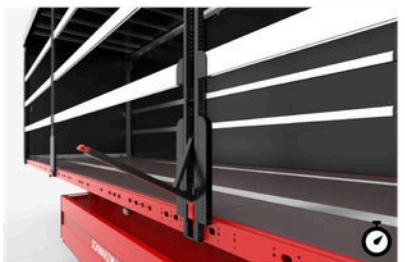
19 Pomični stebri Enostavno in hitro pomikanje srednjega stebra v stran omogoča polno širino nakladalne površine.
