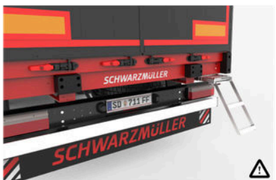
5 Izvleča vzpenjalna letev Za vzpon na nakladalno površino. Najvišja stopnica je opremljena z majhno ploščadjo za večjo stabilnost.
