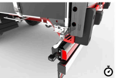
20 Napenjalna raglja Omogoča hitro napenjanje stranskih cerad. Nameščene so na zadnji strani, levo in desno v smeri vožnje.
