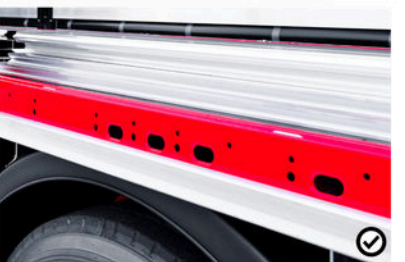
8 Luknjičasti zunanji okvir Poleg pritrdilnih obročev je mogoče na zunanji okvir z luknjami na kateri koli želeni točki namestiti varnostne kavle za pritrditev tovora.
