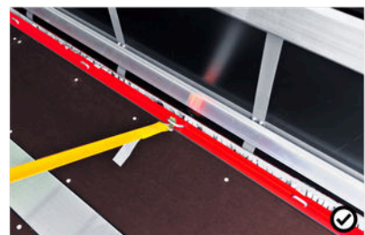
9 Zunanji okvir pritrdilnega nosilca Nahajajo se na zgornjem robu nakladalne površine in omogočajo udobno in enostavno pritrditev tovora.
