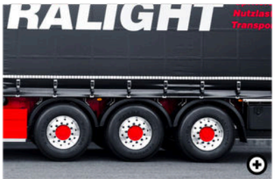
16 Blatnik posameznega kolesa Zmanjša pršenje vode zaradi vrtenja pnevmatik na mokri cesti in tako ščiti spodnjo stran tal.
