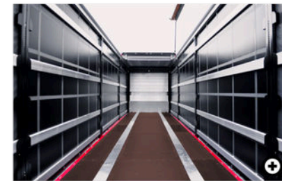
12 Obremenitveni sitotiskani pod Debelina 28 mm, primeren za osno obremenitev viličarja 7.200 kg. Pri izvedbi Paper se uporablja dvojno dno (28 mm + 12 mm) (osna obremenitev viličarja: do 8.000 kg).
