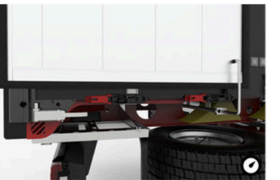
17 Pritrdilna naprava za zadnja vrata Odprta zadnja vrata se fiksirajo, da se ne bi nepričakovano zaloputnila.
