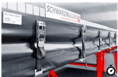
2 Napenjalec cerade Over Center Posebni napenjalci služijo za pritrditev cerade na zunanji okvir in podpirajo zavarovanje tovora.
