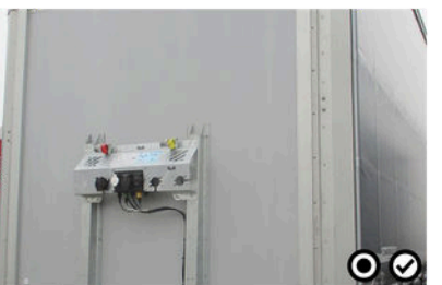
11 Čelna stena Sprednja stena omogoča dodatno zmanjšanje teže za 60 kg, njena izjemna trdnost pa odpravlja potrebo po dodatni zaščiti sprednje stene na notranji strani.
