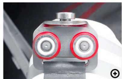
4 Valj Trike Za obešanje stranske cerade. Dva navpična in en vodoravni vodilni valj omogočajo enostavno upravljanje cerade.
