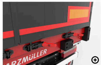
6 Enoročni zaklep vrat Zaklepne ročice zadnjih vrat je mogoče odpirati in zapirati z eno roko.
