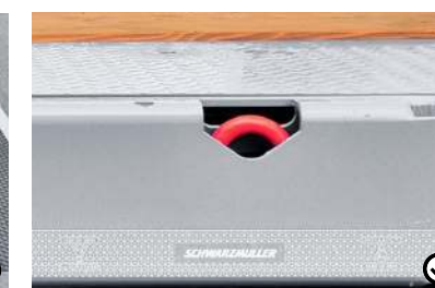
11 Privezni obroči 10 t Odklopni pritrilni obroči služijo za pritrnitev tovora med prevozom.
