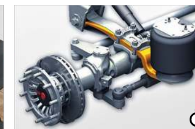
14 Krmilna os Za večjo okretnost prikolice, hkrati pa zmanjša obrabo pnevmatik. Na voljo je kot samosmerna vlečna os ali hidravlično krmiljena os.
