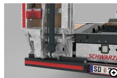
3 Bočno premične rampe Obe rampi je mogoče ročno premikati bočno. Tako je mogoče brez težav natovoriti vozila z različnimi širinami kolotekov.
