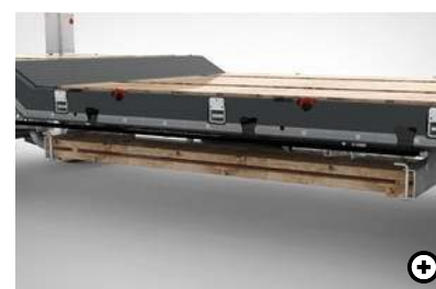
6 Predal za deske za razširitev Lesene podloge za razširitev tovornega prostora so shranjene v odlagalnem prostoru pod tovorno površino.
