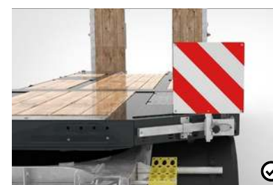
7 Raztegljive opozorilne table Njihova naloga je prilagodljivo označevanje širine vozila, da se zagotovi varen prevoz vozil s prekomerno širino.
