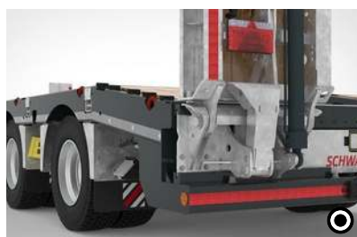
4 Zložljive podpore na rampah Ob odprtju rampe se podstavki samodejno iztegnejo. S tem preprečijo, da bi se prikolica med nakladanjem na sprednjem delu dvignila navzgor.
