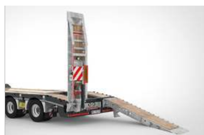
2 Zložljiva enodelna rampa Zložljiva enodelna nakladalna rampa se za vožnjo na nakladalno površino spusti navzdol.
