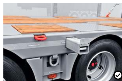
5 Raztegljive razširitve Nosilci tovora se lahko izvlečejo do širine 3 metrov. To omogoča prevoz širših vozil.
