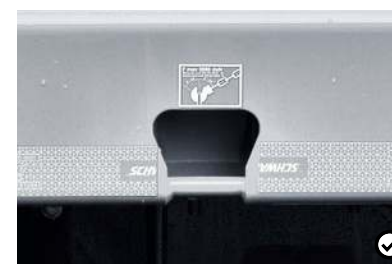
12 Privezne letve 4 t Pritrdilne prečke, tako kot pritrilni obroči, služijo za pritrnitev tovora.
