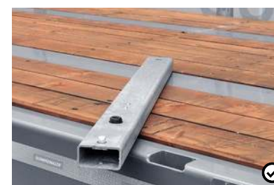
9 Žepi za profilne cevi Žepi v zunanem okvirju so primerni za vgradnjo oblikovanih cevi.
